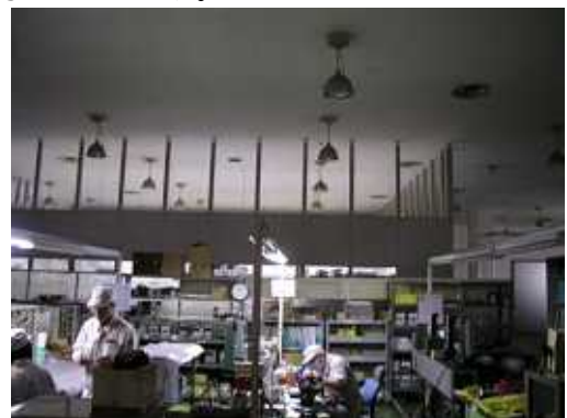
天井照明を消し、手元照明で作業
