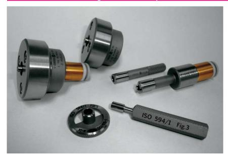
ルアーテーパ(luer taper) は、国際的に使用されている接続方法のひとつで、オスルアー (male luer) と、メスルアー (female luer) の2種類があります。 差し込むだけで簡単に気密性のよい接続が可能で、注射器をはじめ、医療機器、理化学器具を中心に広く採用されています。接続口は直径約4mmの円形で、6/100 のテーパを持ち、詳細は「ISO594」で規定されています。ルアーテーパゲージはISO規格を満たし使い勝手を向上した新設計で、ゲージメーカーゆえの高精度な寸法管理を実現します。
