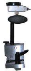
てこ式インジケータ(外径用) Lever type indicator (For external dia.)
