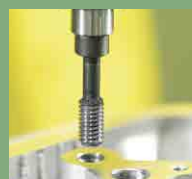
ねじプラグゲージで タップ穴の通り検査 thread plug gauge
