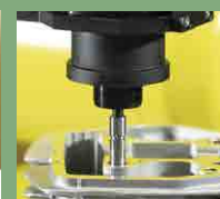
片ロプラグゲージで 穴の通り止り検査 Single-ended Go and NoGo plug gauge
