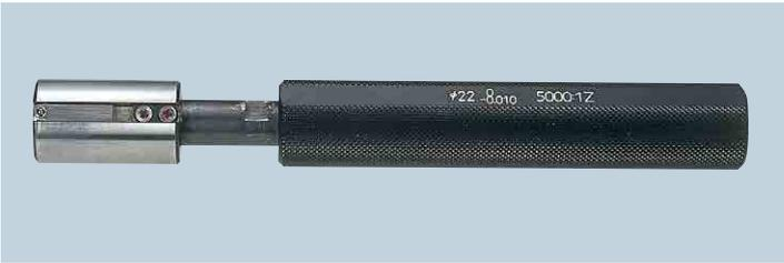
超硬ボール付板バネを用いた接触式の測定ヘッドです。測定面の幅4mm以下のもの、表面粗さが $3.2\mu\text{mRy}$  (Rmax) を超えるものに適します。さらに止り穴に適用すると最深部の測定が可能です。
