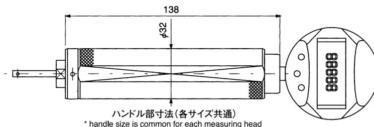
精密加工技術によって製作され、高精度で耐摩耗性に富んでいます。空気マイクロメータ本体と組み合わせて、能率的な測定や省力化、合理化の手段としてご使用をおすすめします。
