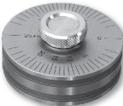
ロータリーゲージは、塗料、インキ等の未乾燥状態塗膜の膜厚測定に使用します。2つの同心円盤(外輪)と内側の偏心した円盤(中央輪)で構成されています。測定範囲は0~25μm、0~50μmから選択可能。硬度は一般的なゲージと同等でありながら従来の焼入れ可能なステンレス鋼よりも高い耐食性の材質を使用しています。
