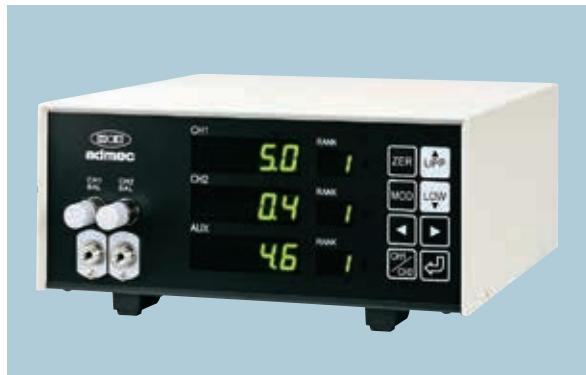
admecはコンパクトで操作性に優れた高精度な空気マイクロメーターです。高度機能を簡単操作で実現したA1(1ch)タイプとA1の機能に2ch同時測定やチャンネル間演算機能が加わったA2(2ch)タイプの2機種を基本に演算機能も多彩で様々な測定ニーズに応えます。また同一機能の電気マイクロメータも製作いたします。ワンチップマイクロコンピュータ方式のため、コストパフォーマンスに優れています。全機種標準でRS-485出力を搭載しているのでインターフェイスを介して、コンピュータへのデータ送信、コンピュータからのパラメータ設定が可能です。また、ランク判定出力及び外部制御入力、温度補正用アナログ入力を標準装備し、自動測定等多くのFAニーズに対応します。
