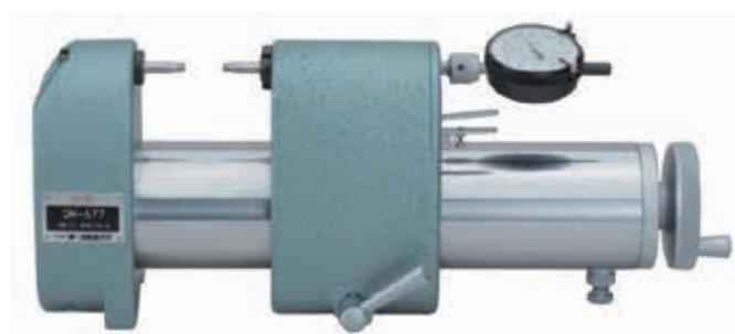
同じサイズの部品をまとめて測定する場合に最適です。低コストで高精度。ワークの内径、外径、有効径の測定に作業現場や検査室などで活躍します。表示器はダイヤルゲージ、電気マイクロが選択可能。載物面付仕様(オプション)でテーパねじ四針測定ができます。測定物の保持にはスタンド(オプション)をお薦めします。
