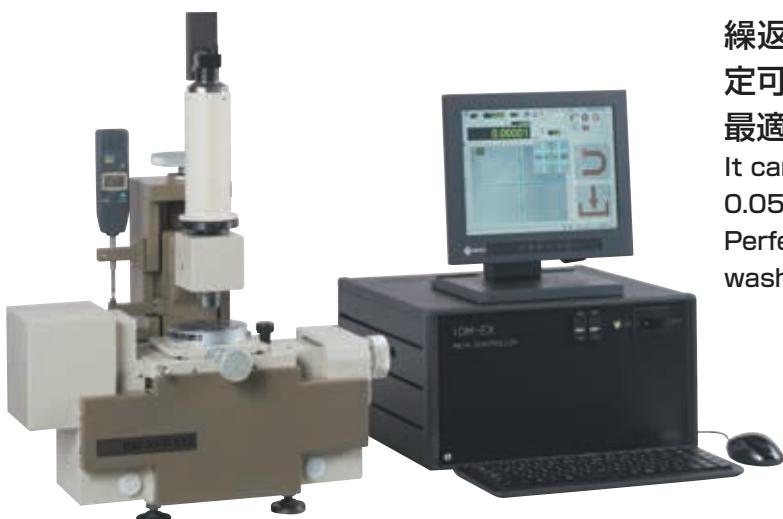
**繰返し精度0.05μm、厚み0.1mmまで測定可能。ワッシャーなどの薄いワーク測定に最適。**
