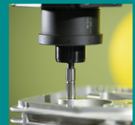
片ロプラグゲージで穴の 通り検査 Single ended Go and NoGo plug gauge
