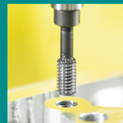
ねじプラグゲージで タップ穴の通り検査 Thread plug gauge
