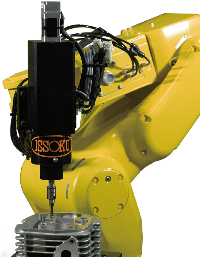
ねじプラグゲージで タップ穴の通り検査 Thread plug gauge
