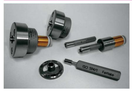
ルアーテーパ(luer taper) は、国際的に使用されている接続方法のひとつで、オスルアー (male luer) の2種類があります。 差し込むだけで簡単に気密性のよい接続が可能で、注射器をはじめ、医療機器、理化学器具を中心に広く採用されています。接続口は直径約4mmの円形で、6/100 のテーパを持ち、詳細は「ISO594」で規定されています。ルアーテーパゲージはISO規格を満たし使い勝手を向上した新設計で、ゲージメーカーゆえの高精度な寸法管理を実現します。
