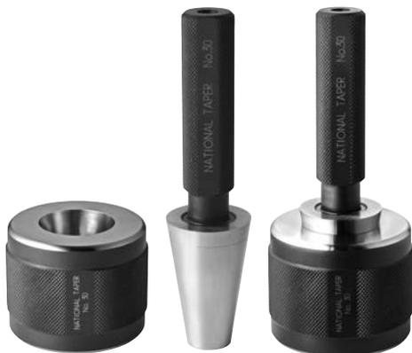
テーパゲージはテーパ製品のテーパとテーパの基本径(大端径又は小端径)の検査に用いられます。一般にテーパプラグゲージとテーパリングゲージとからなり、はめあった一組の標準ゲージの形式となりますが、切欠きを設け製品の基準とすべき端面が止る位置を限界式にわかるようにしたのもも製作致します。(図参照)
