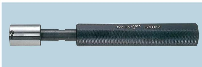
リーフ式同様接触式の測定ヘッドです。主にリーフ式での測定が困難な場合に採用される他、空気の流れにより超硬ボールの測定子が測定面を転がりますのでボールの磨耗が少なく測定ワークのキズ発生が少ない特長があります。
