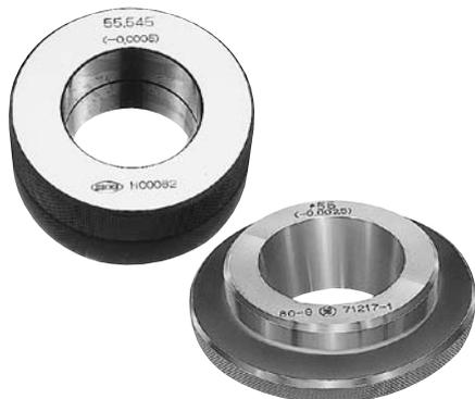
マスタゲージは比較測定器の寸法設定などの寸法基準として用いられるゲージです。Master gauges are used for setting-up of relative measuring instruments, as dimensional standards.
