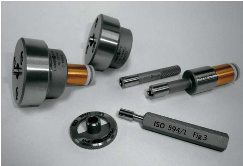
ルアーテーパ(luer taper) は、国際的に使用されている接続方法のひとつで、オスルアー (male luer) と、メスルアー (female luer) の2種類があります。差し込むだけで簡単に気密性のよい接続が可能で、注射器をはじめ、医療機器、理化学器具を中心に広く採用されています。接続口は直径約4mmの円形で、6/100 のテーパを持ち、詳細は「ISO594」で規定されています。ルアーテーパゲージはISO規格を満たし使い勝手を向上した新設計で、ゲージメーカーゆえの高精度な寸法管理を実現します。
