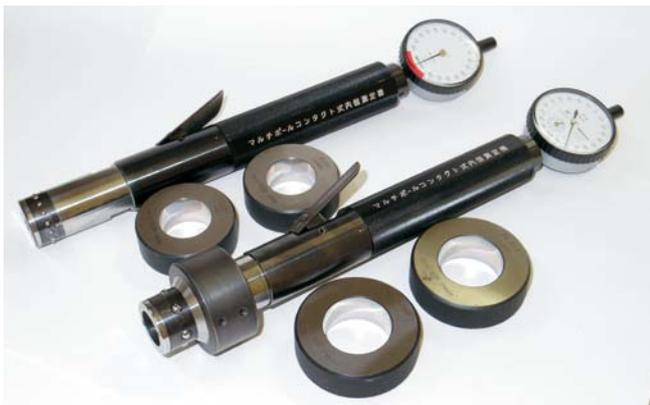
リファレンスバー(PAT)方式により簡単に高精度な内径測定が可能です。
