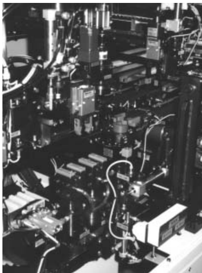
自社製空気マイクロメータを使用した測定部 Measuring station with our original “Air Gages”.
