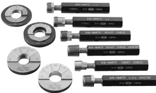
NPT同様、ANSI規格(アメリカ)の管用耐密テーパねじNPTFの検査に使用するテーパねじゲージです。テーパねじリングゲージにはL1ゲージ及びL2ゲージ、テーパねじプラグゲージにはL1ゲージ及びL3ゲージがあります。基本的にL1ゲージではワークの基準径の位置を含めた総合的な検査を行い、L2又はL3ゲージは、L1ゲージでは検査されないレンチ締めの際に必要となるワークねじ部の検査を行います。(ゲージをワークにねじ込む際は、いづれのゲージも手締めとなります。)
