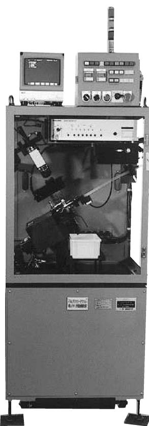
ローラ焼入パターン自動検査装置
