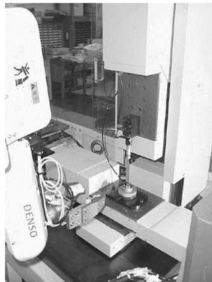
自社製精密テーブルで構築した三次元測定部
