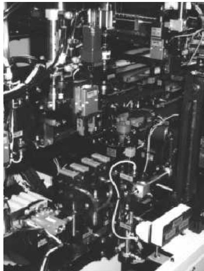
自社製空気マイクロメータを使用した測定部
