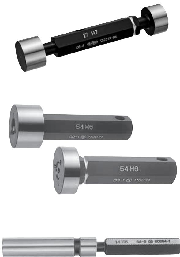
穴用限界ゲージは穴の最小実体寸法を基準とした測定面と最大実体寸法を基準とした測定面をもつゲージです。
