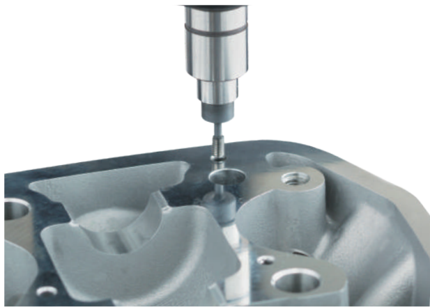
検査例：50ccバイク用エンジンのシリンダーヘッド
