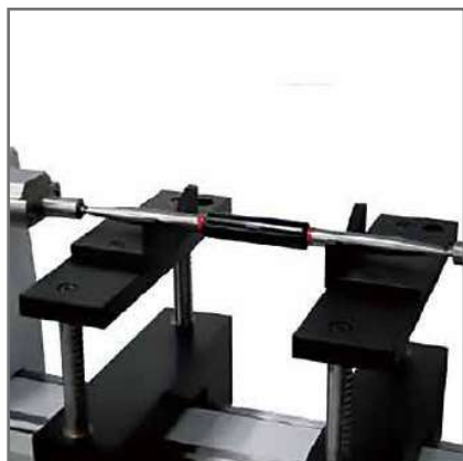
棒ゲージの校正 (TELMA7/TELMN7.2)
