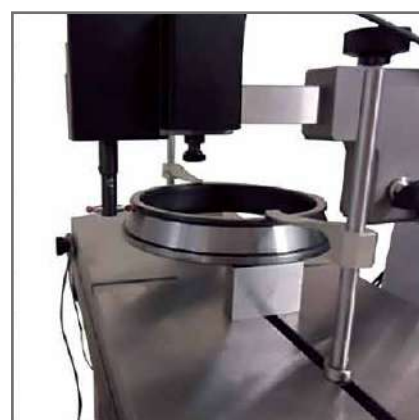
CNCコントロールの外側テーパ リングの測定
