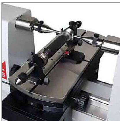
ねじプラグゲージの校正 (3P/0.17-3.2/S6.5/TA-SU-315)
