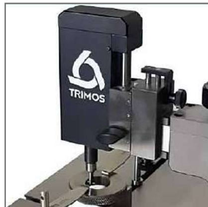
ねじリングゲージの校正 (TA-MS-370/TEL75/TA-SU-354)
