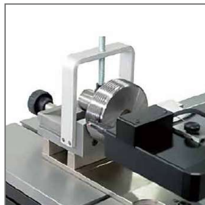
テーパねじプラグゲージの検査 (TA-MS-381/TEL75)
