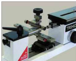
フローティングサポートを使ったプラグゲージとねじプラグゲージの校正 (THV-115)
