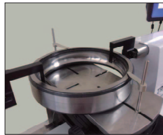
CNC コントロールの ベアリングリングの内側測定
