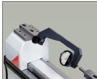
ダイヤルインジケータの検査 (TULM5C)
