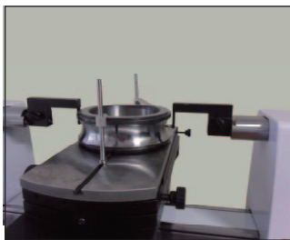
CNC コントロールの ベアリングリングの外側測定
