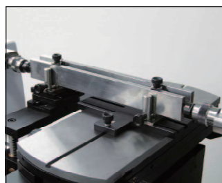
250mm以上のゲージブロックの比較測定 (TA-SU-307/TEL7/TELMA7)
