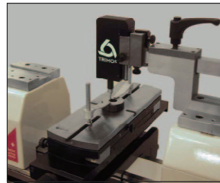
小径リングゲージの校正 (TA-SU-313/LABC-70/TA-SU-354)
