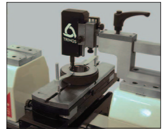
ねじリングゲージの校正 (TA-SU-313/LABC-70/TA-SU-354)
