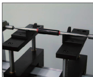
棒ゲージの校正 (TELMA7/TELMN7.2)
