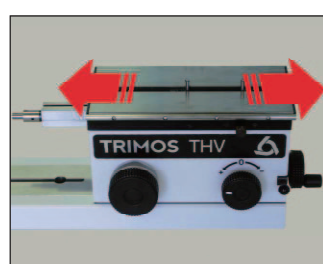
より正確な内側測定のためのフローティングテーブル
