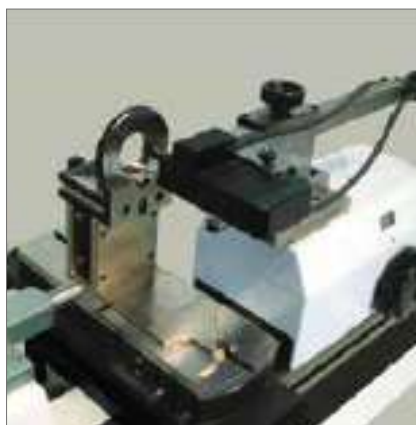
テーパねじリングゲージの検査 (HPA-1, LABC80)
