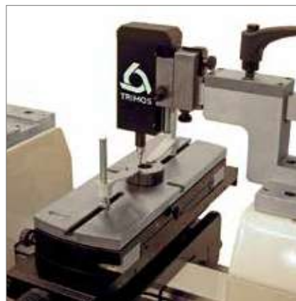
小径リングゲージの校正 (TA-SU-313, TA-MS-370, TEL76, TA-SU-354)
