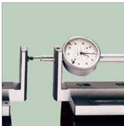
ダイヤルインジケータの検査 (TA-IH-301)
