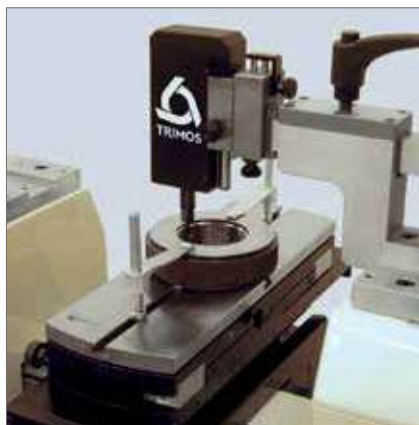
ねじリングゲージの校正 (TA-SU-313, TA-MS-370, TA-SU-354, TUM13.2, TA-MS-307)
