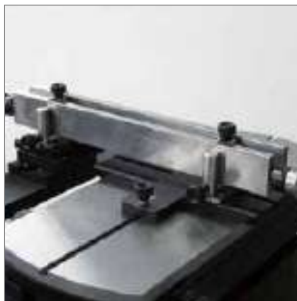
250mm以上のゲージブロックの 比較測定 (TA-SU-313, TA-SU-305)
