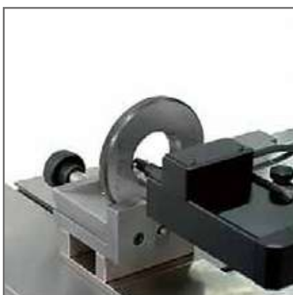
テーパねじリングゲージの検査 (TA-MS-381/TEL75)
