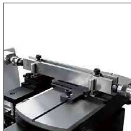
250mm以上のゲージブロックの比較測定 (TA-SU-307/TEL7/TELMA7)
