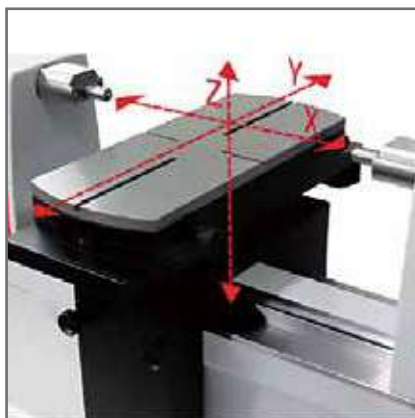
反転ポイントの自動サーチができる CNC コントロール測定
