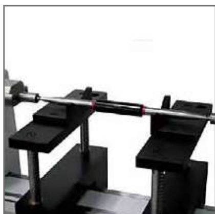
棒ゲージの校正 (TELMA7/TELMN7.2)
