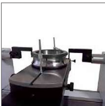
CNC コントロールの ベアリングリングの外側測定
