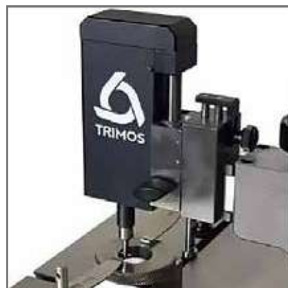
ねじリングゲージの校正 (TA-MS-370/TEL75/TA-SU-354)
