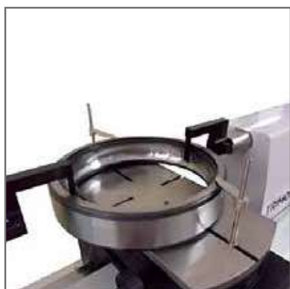
CNC コントロールの ベアリングリングの内側測定
