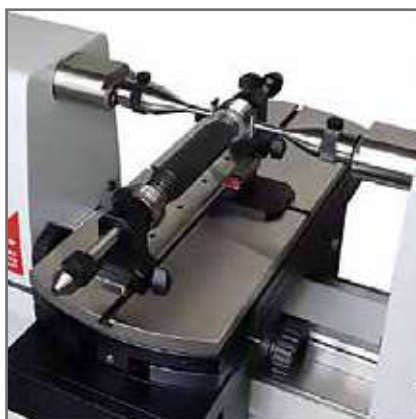
ねじプラグゲージの校正 (3P/0.17-3.2/S6.5/TA-SU-315)
