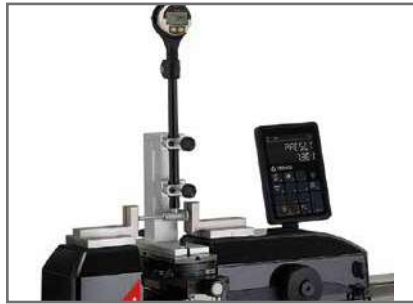
二点式ボアゲージの治具を 使ったセッティング
