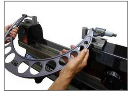
外測マイクロメータの手による セッティング
