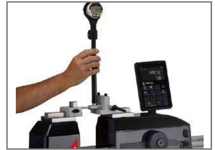
二点式ボアゲージの手による セッティング
