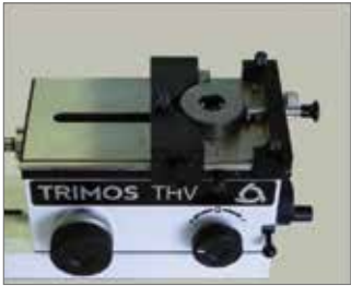
リングゲージの校正 (THV-260)
