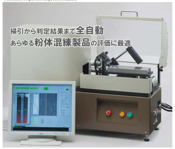
ADIM は粉体混練製品の組織粒の分散具合を自動で評価する事ができます。これまで属人性の高かった粒度ゲージによる目視評価を画像処理により定量化。製品の添加粒子や素材粒子によって形成されるパターンを自動判定します。
