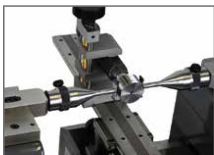
ねじプラグゲージの測定例
