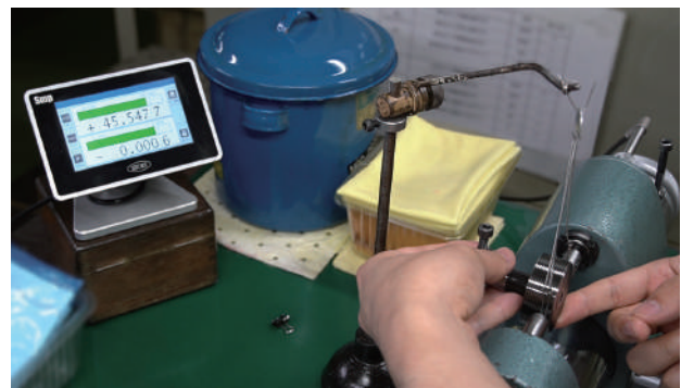
三針法によるねじ有効測定 (比較測長機使用)
