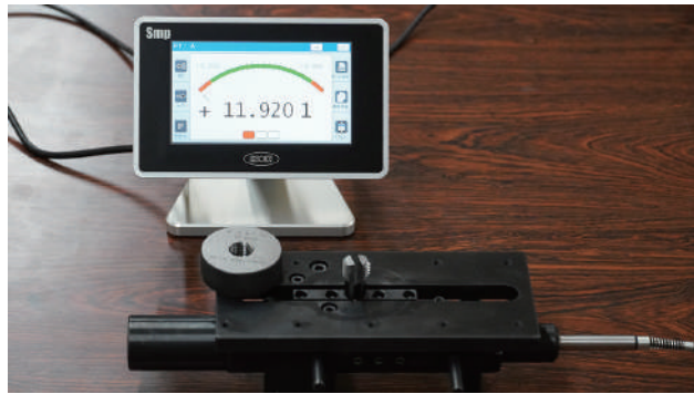
ねじ有効径測定 (簡易比較測長機使用)
