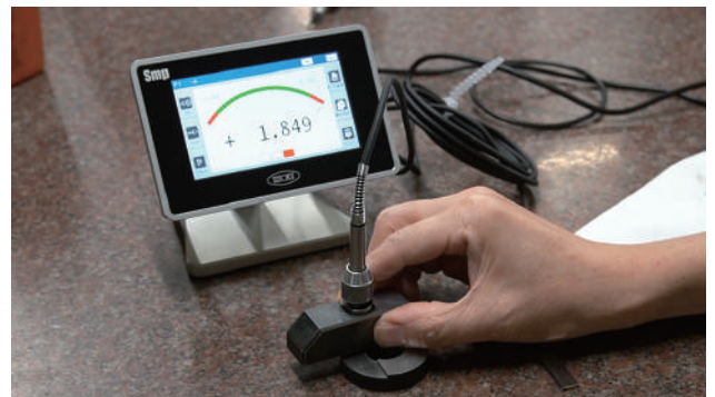
段差測定 (デプスゲージ使用)
