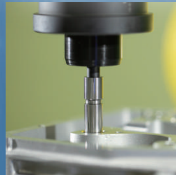
片口プラグゲージで 穴の通り/止りを検査
